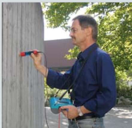
Medición con electrodo de varilla conforme a las normas.
