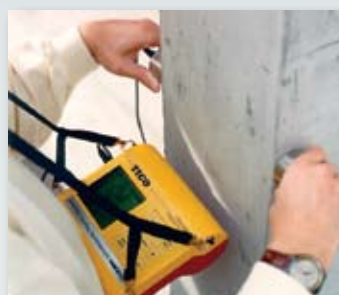
Transmisión indirecta o de superficie
